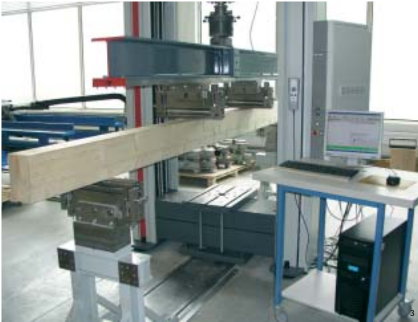
3 Mit der Universalprüfmaschine können verleimte, tragende Massivholzprodukte und mechanische Verbindungsmittel geprüft werden
