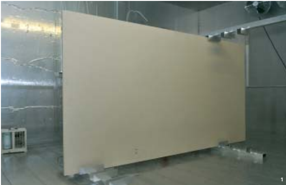
1 Emissionsprüfung einer Spanplatte gemäß CARB Bestimmungen am Institut 2 Xenon-Bewitterungsgerät mit Feuchterege lung erhöht die Schnellbewitterungskapazität der HFA
