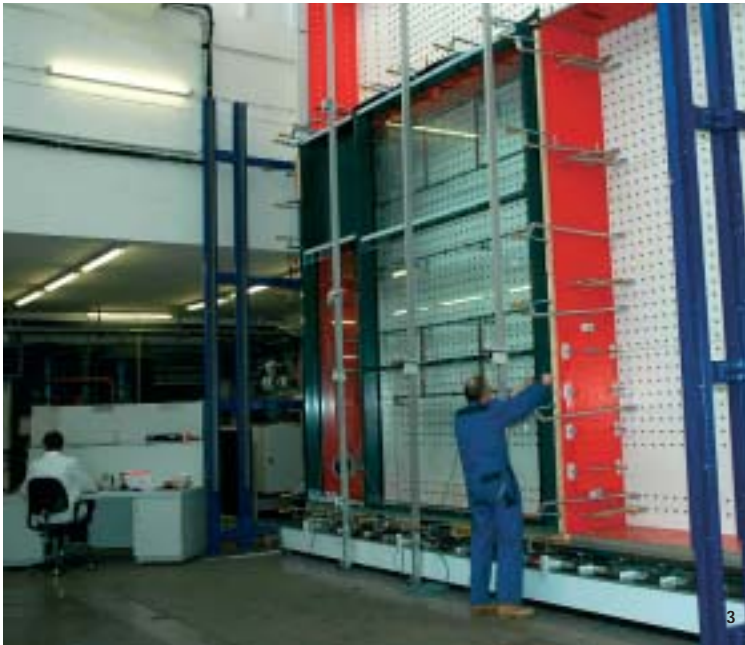
3 Mit dem Fassadenprüfstand können Elemente bis 6 x 6 m Größe getestet und neue Fragestellungen bearbeitet werden
